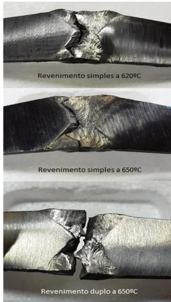
**Figura 4.8** Fratura dos corpos de prova no ensaio de dobramento
