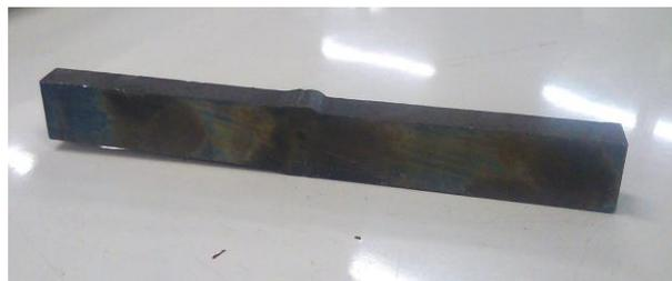
**Figura 3.3:** Amostra da ZTA com revenimento posterior a soldagem
