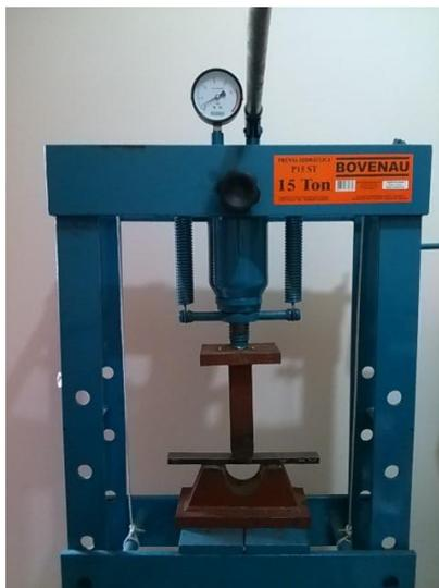
**Figura 3.7:** Prensa hidráulica vertical de 15 toneladas
