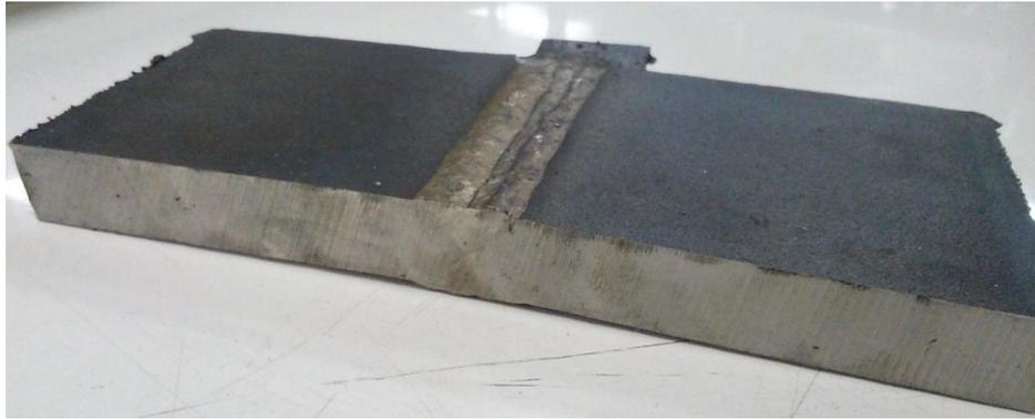
**Figura 3.1:** Junta soldada fornecida.
