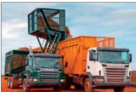
Figura 24 – Caminhão de Transbordo Repassando Matéria Prima
