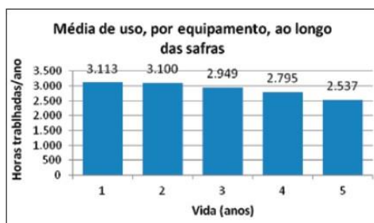
Figura 18 – Médio de Uso de uma Colhedora Durante Cada Safra Fonte: Banchi et al. 2012
