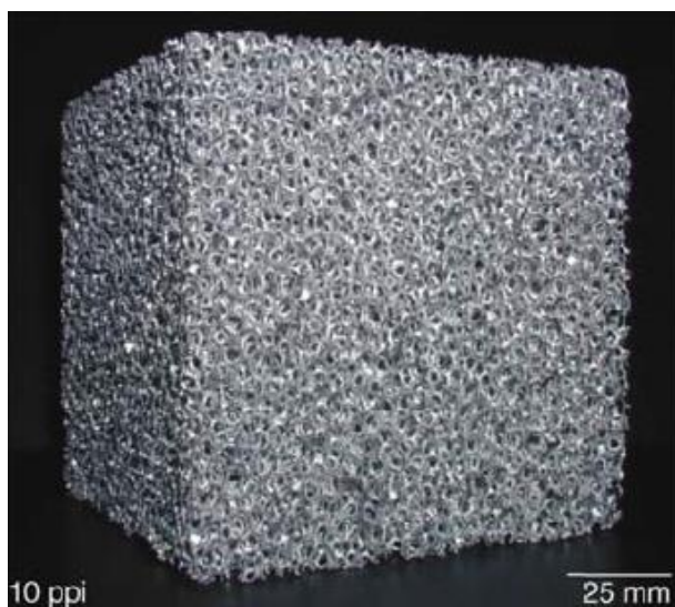
Figura 2 – Meio poroso sintético de FeCrAlY Fonte: Zhao, 2012
