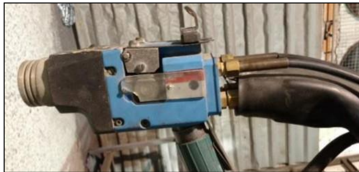
Figura 15 - Pistola de aplicação Metco para aspersão à arco elétrico.
