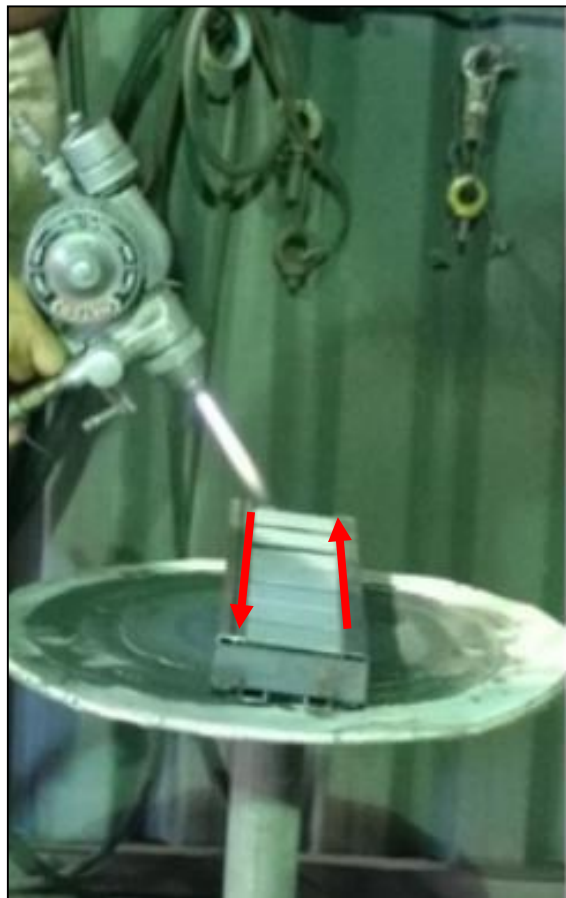
Figura 13 - Sentido de aplicação do revestimento para o processo de aspersão térmica à chama convencional. Fonte: Autoria própria (2018).
