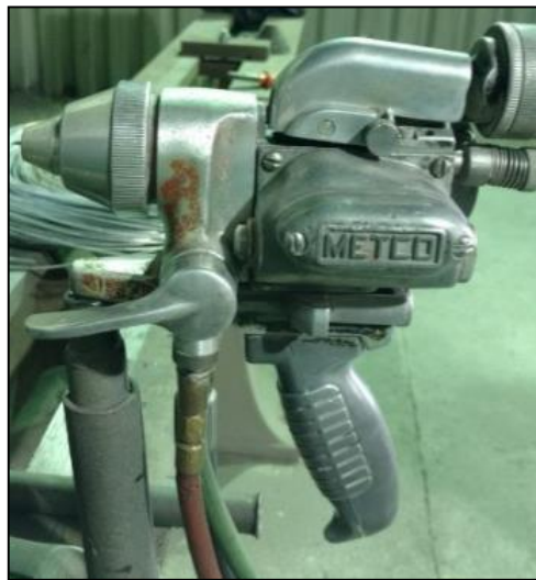
Figura 14 - Pistola de aplicação Metco para aspersão à chama convencional. Fonte: Autoria própria (2018).
