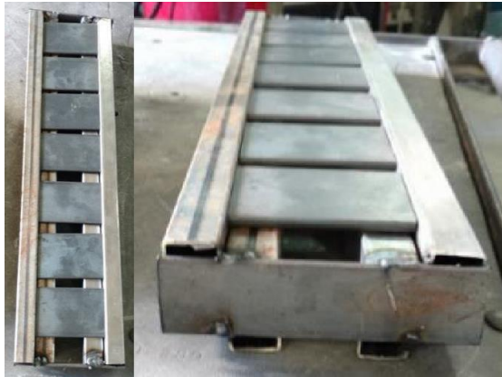
Figura 12 - Dispositivo de fixação para aspersão das amostras. Fonte: Autoria própria (2018).
