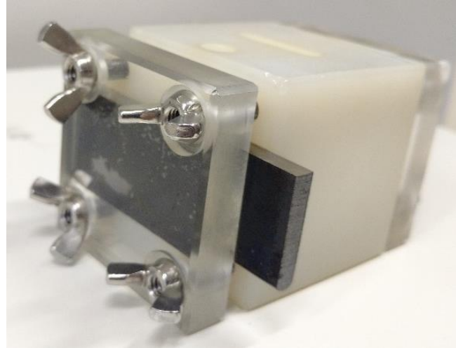
Figura 23 – Posição de fixação do corpo de prova do dispositivo de ensaio OCP. Fonte: Autoria própria (2018).
