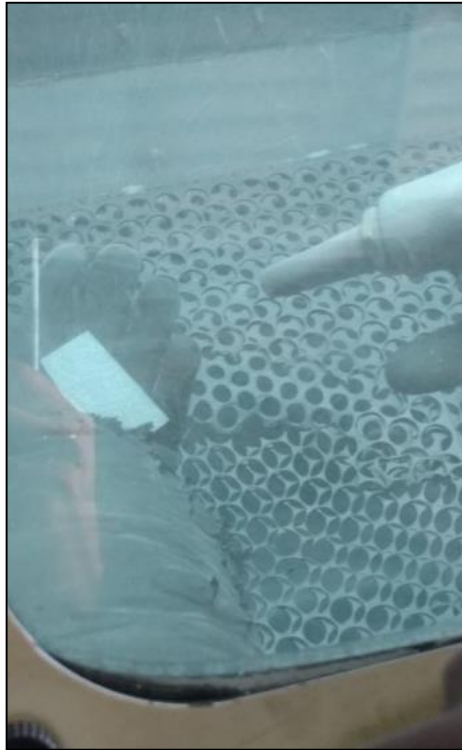
Figura 11 - Operador realizando a preparação das amostras por meio do processo de jateamento. Fonte: Autoria própria (2018).
