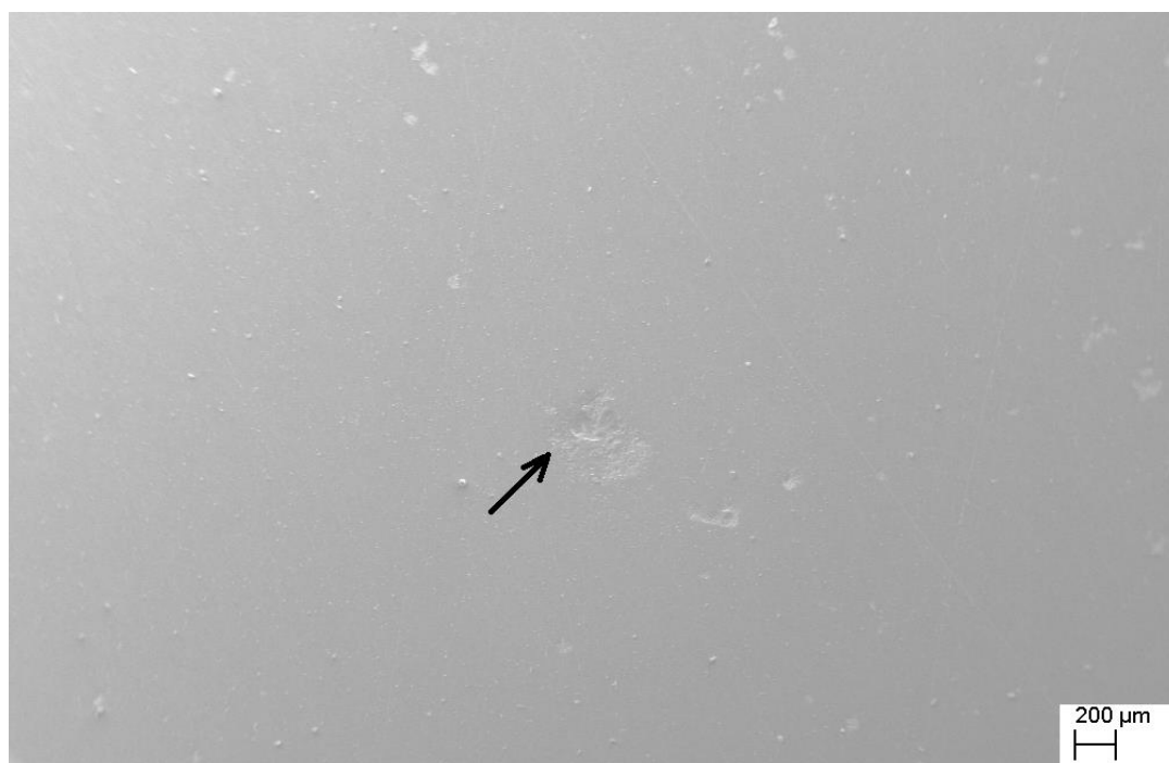
Figura 24 - Pite indicado pela seta na amostra F (segundo grupo de testes)
