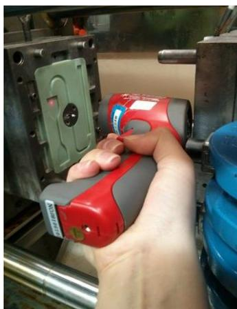
**Figura 3.7 – Medição da temperatura do inserto**
