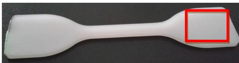
**Figura 3.12 – Região das medições de dureza**
