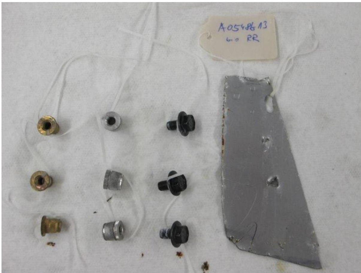
Figura 24 – Teste de corrosão por contato
