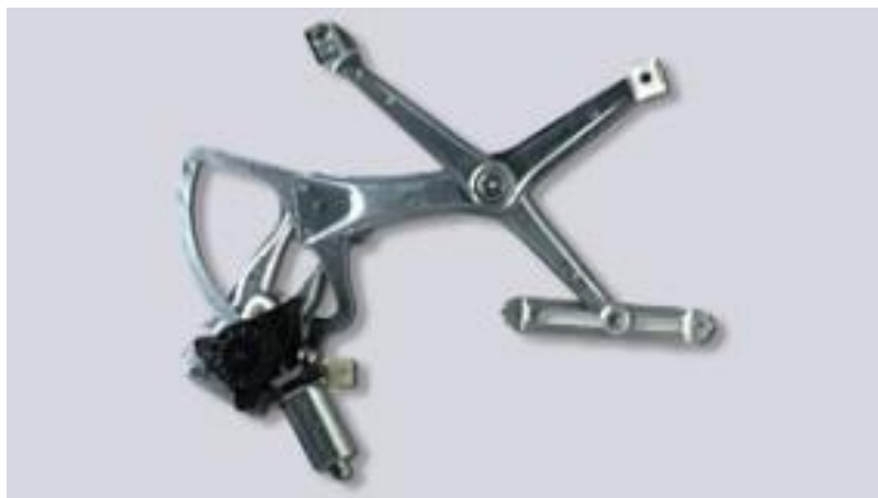
Figura 5 – Levantador de vidro single-arm
