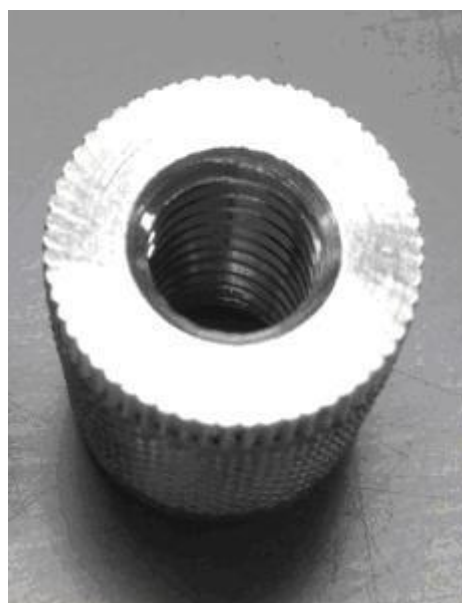
Figura 4 – Inserto metálico de alumínio (6082-T6)
