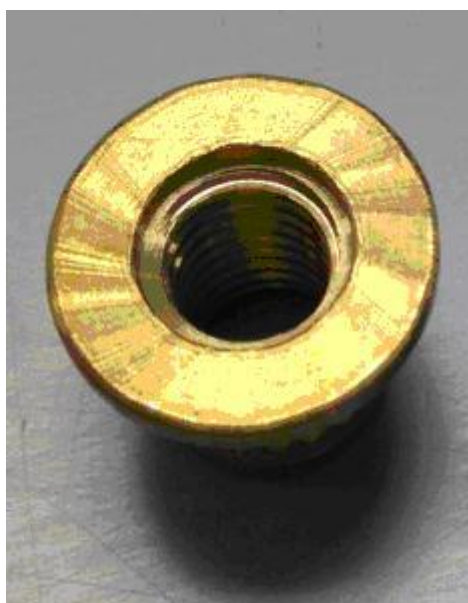
Figura 3 – Inserto metálico de liga de latão (CuZn39Pb3)
