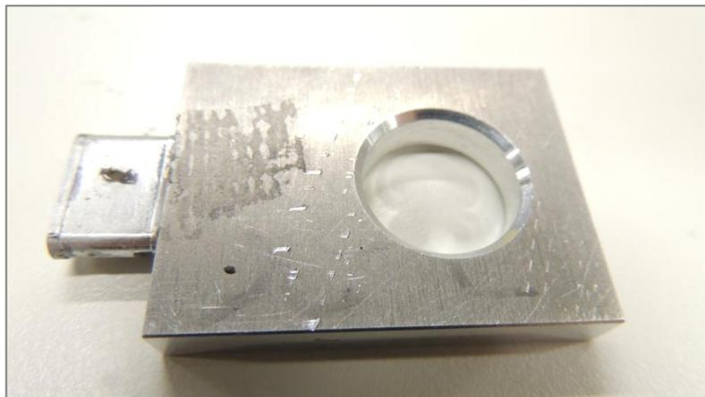
**Figura 3.13 – Inserto metálico modificado para realização de teste de tração e da cola entre compósito e metal**
