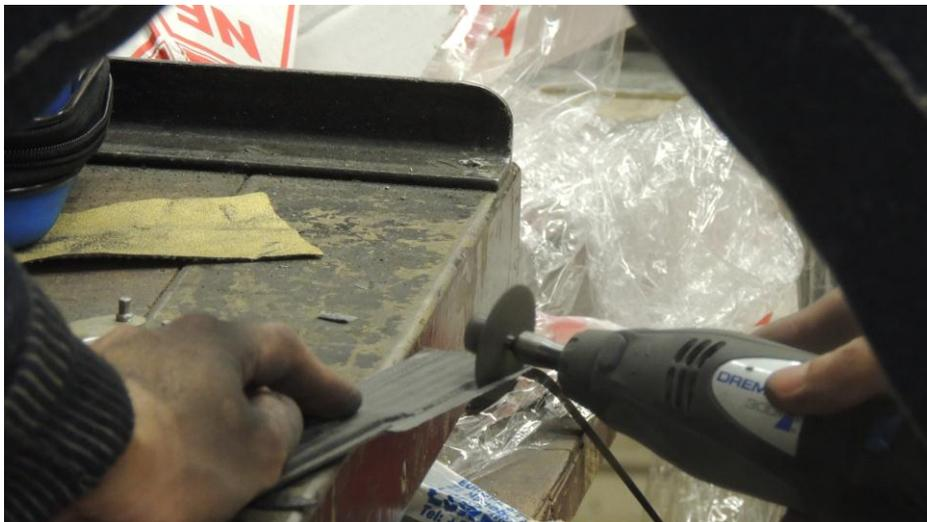
**Figura 7.9 – Remoção das rebarbas a partir de uma lixadeira**
