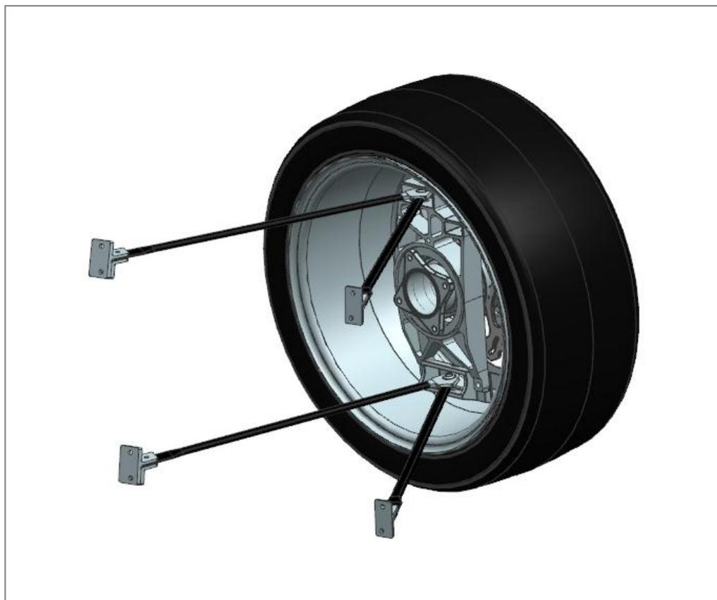
**Figura 5.5 – Ilustração dos componentes da suspensão montados na roda**
