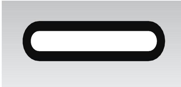
**Figura 3.7 - Representação esquemática do perfil oblongo**
