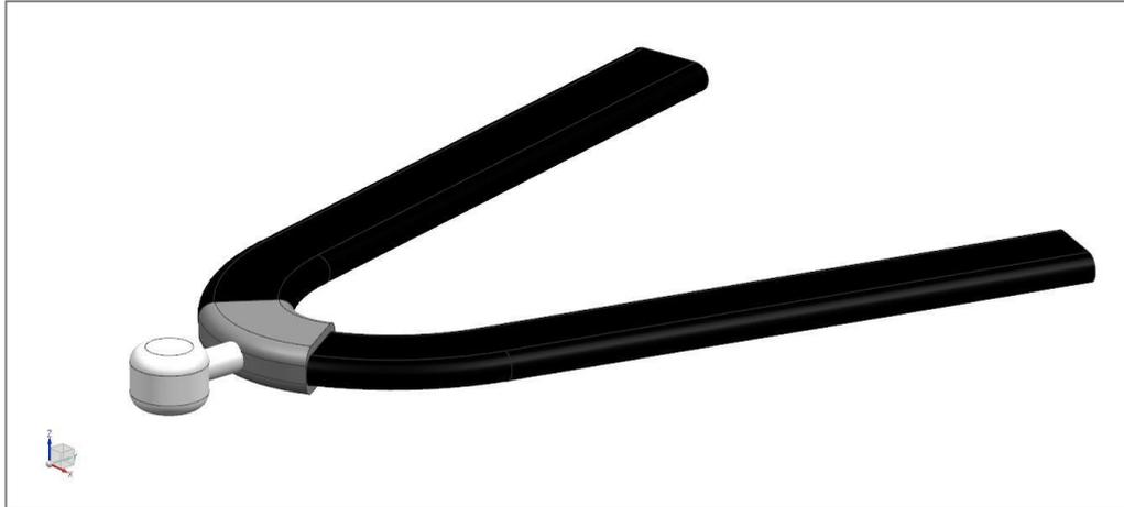
**Figura 3.10 – Conexão à roda metálica com junta esférica ligada por uma haste e dois braços separados de material compósito**
