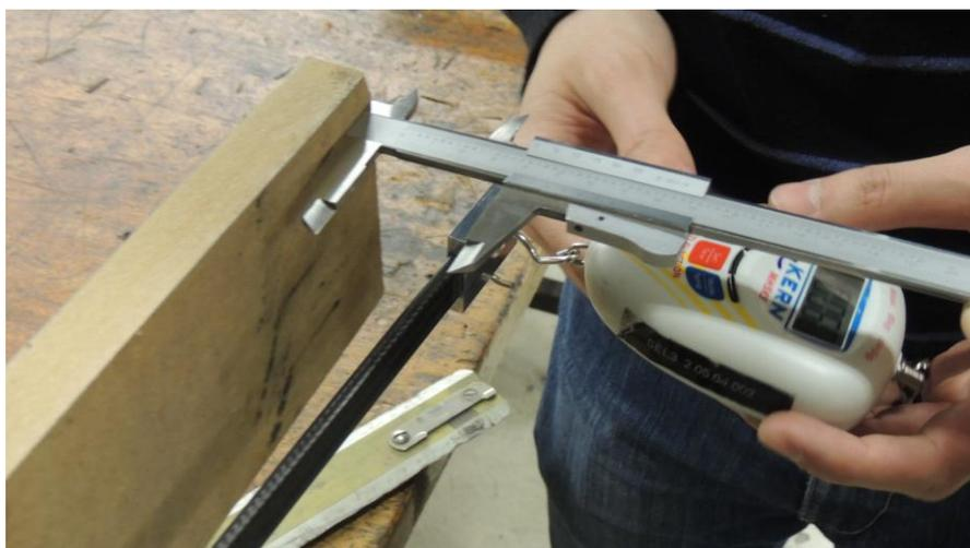
**Figura 8.2 – Realização do teste de deflexão da placa flexível**
