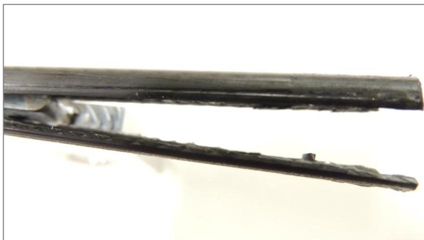
**Figura 8.5 – Fratura no osso após realização do teste de tração**
