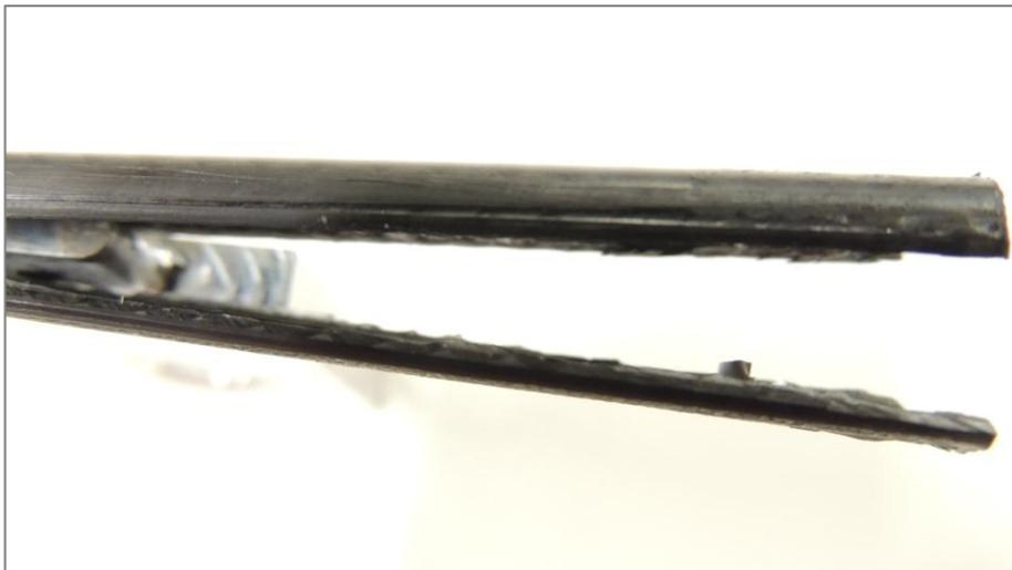
**Figura 7.3 – Fratura obtida durante o teste do primeiro layout de lâminas**
