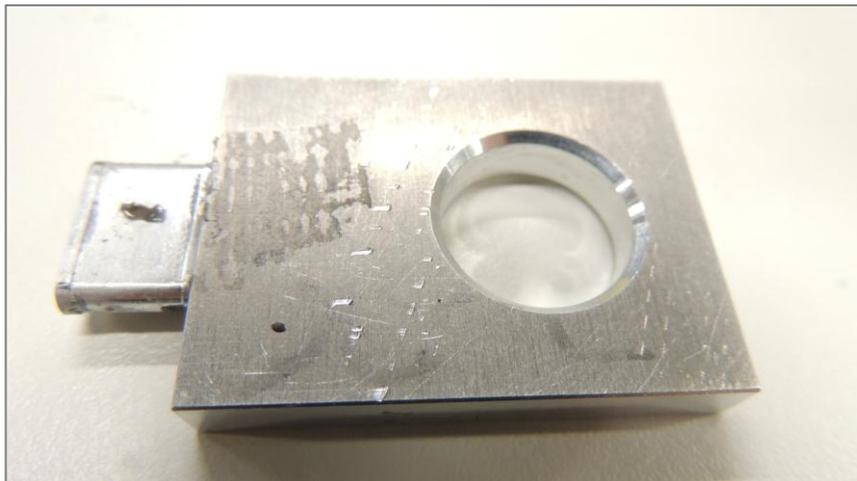
**Figura 8.4 – Inseto metálico após realização do teste de tração**
