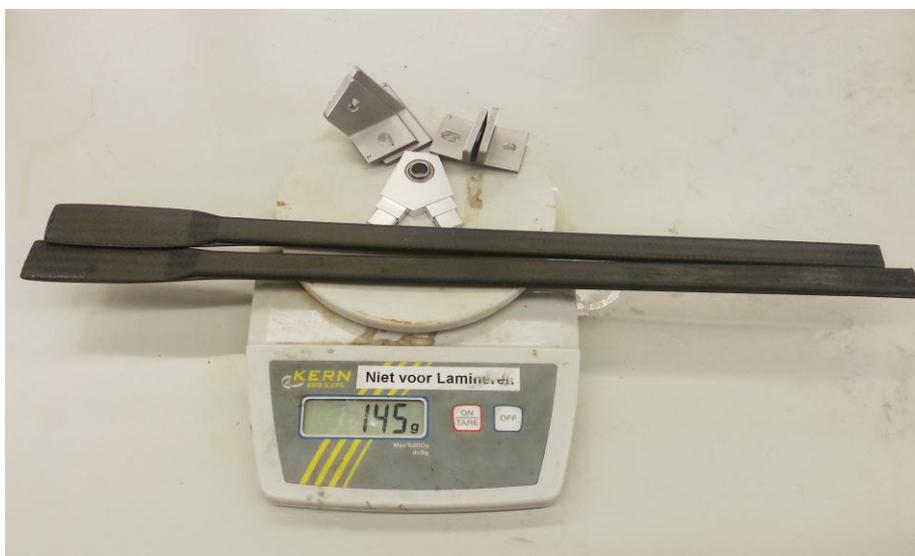
**Figura 8.8 – Balança mostrando o peso do protótipo da suspensão**
