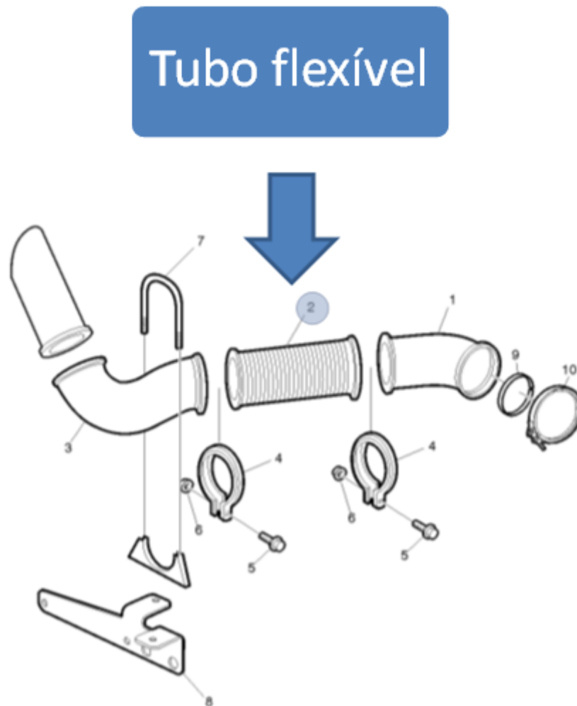
Figura 14 - Desenho do Tubo Flexível do Escapamento Fonte: Adaptado do Material de Pré-investigação da Montadora
