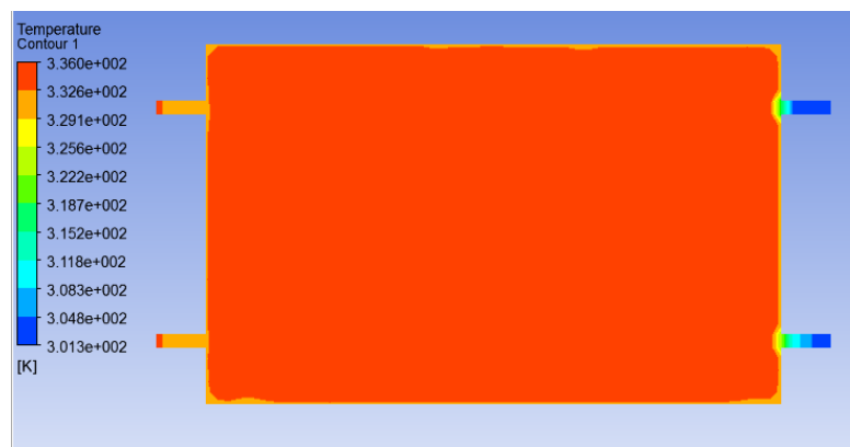
Figura 52. Distribuição de temperatura para o reservatório (sem uso) Fonte: autoria própria
