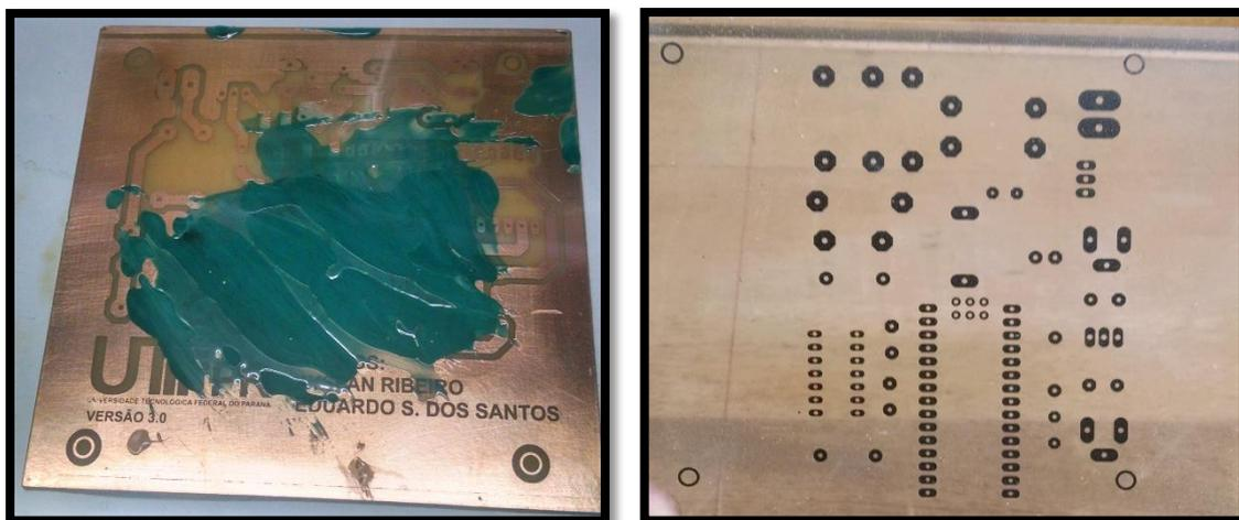
**Figura C.0.13 - Aplicação da máscara de solda (esquerda) e fotolito para realização da máscara (direita).**
