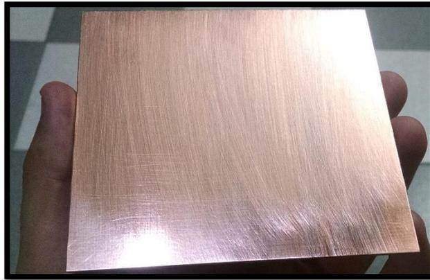
**Figura C.0.5 - Placa utilizada para transferência do circuito.**
