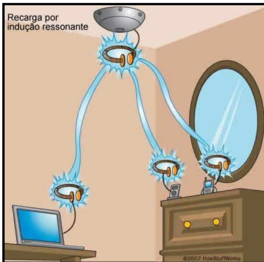
**Figura 1.1 - Emissor e receptores para transmissão de energia por circuitos ressonantes.**
