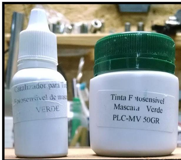
**Figura C.0.12 - Tinta utilizada para máscara de solda e seu catalisador.**
