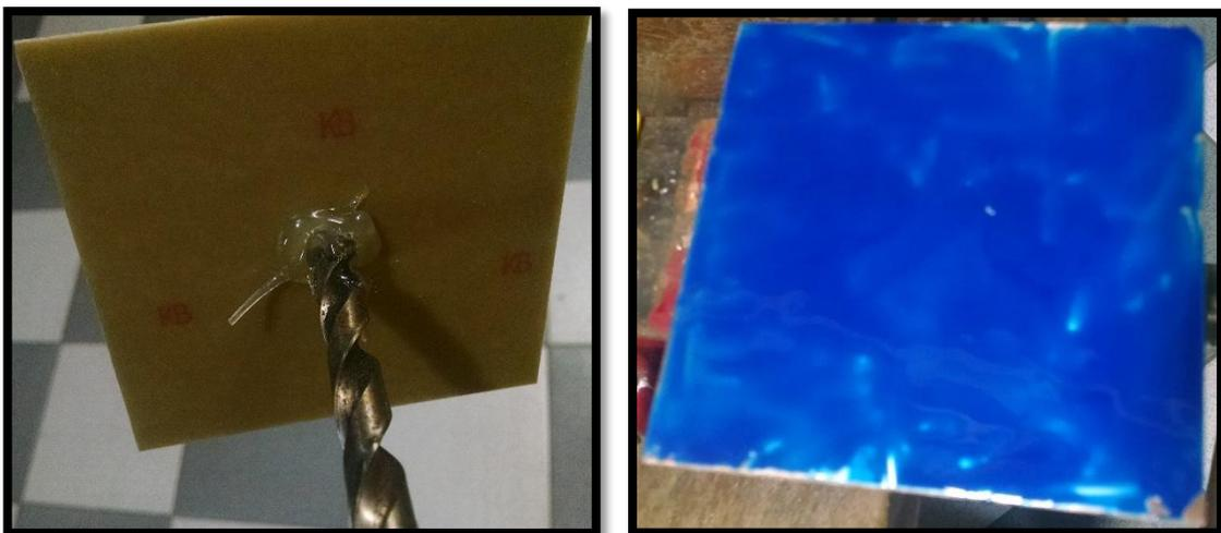
**Figura C.0.6 - Fixação da placa para centrifugação (esquerda) e a placa com a tinta aplicada antes da centrifugação (direita).**
