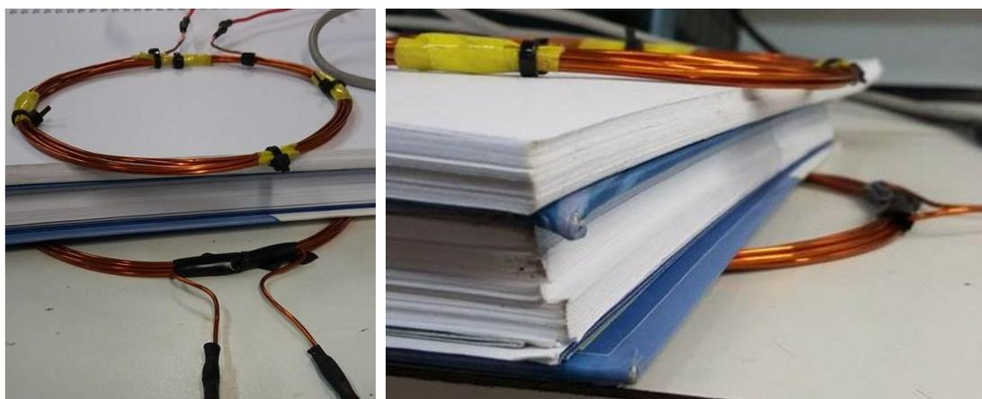
**Figura 5.20 – Bobinas espaçadas em 2,5 cm.**
