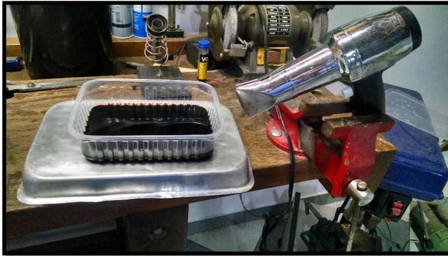
**Figura C.0.11 - Processo de corrosão da placa com elevação da temperatura.**
