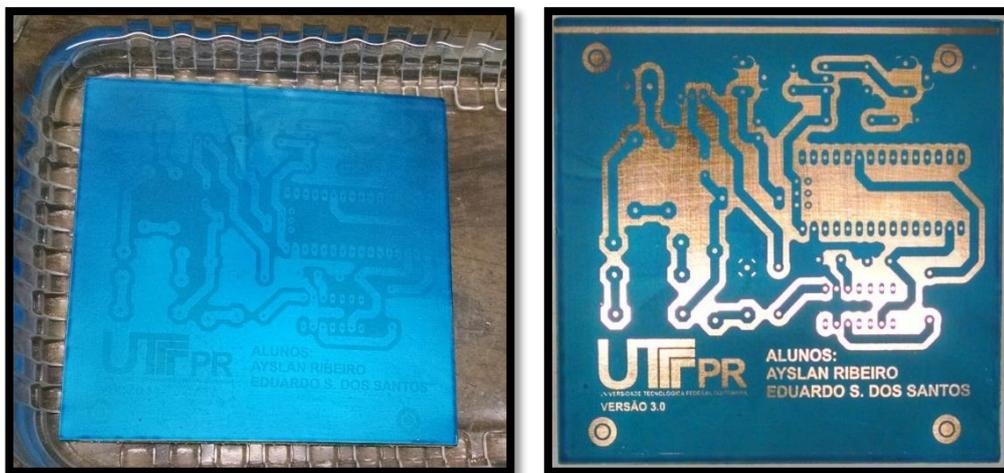
Figura C.0.10 - Placa durante a revelação (esquerda) e placa pós-revelação (direita).
