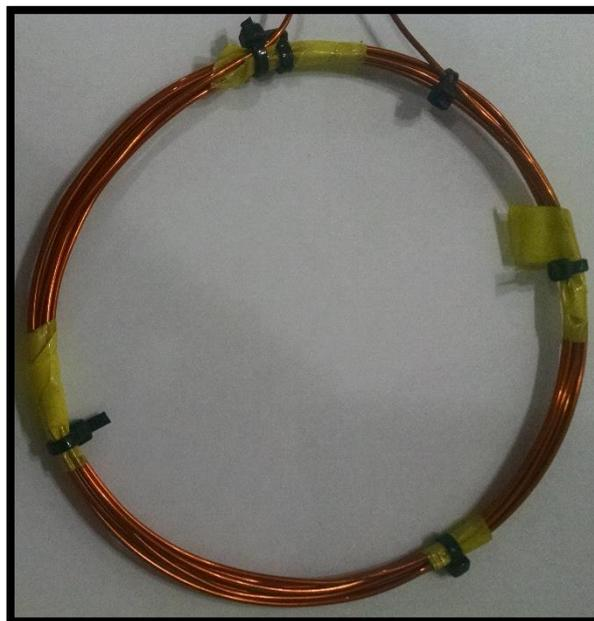
**Figura 4.7 - Bobina secundária para acionamento do LED**
