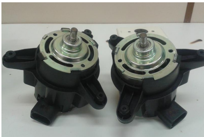
Figura 40: motores HVAC sem carga no eixo
