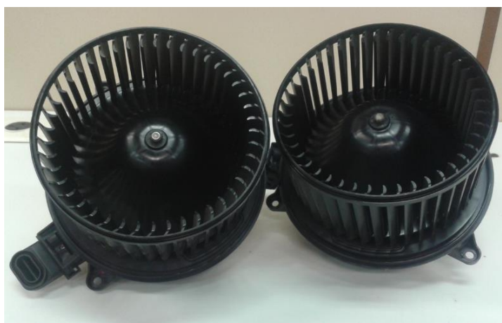
Figura 41: motores HVAC com carga no eixo
