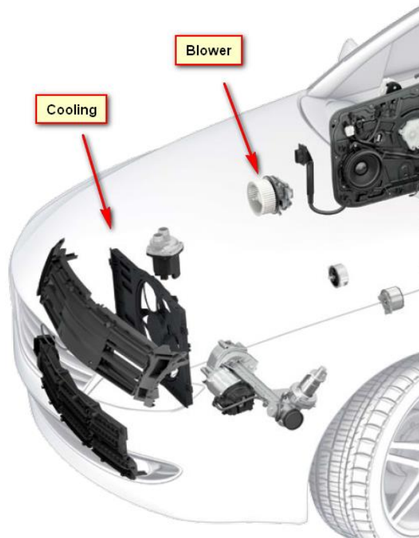
Figura 5: posicionamento dos módulos de arrefecimento nos automóveis
