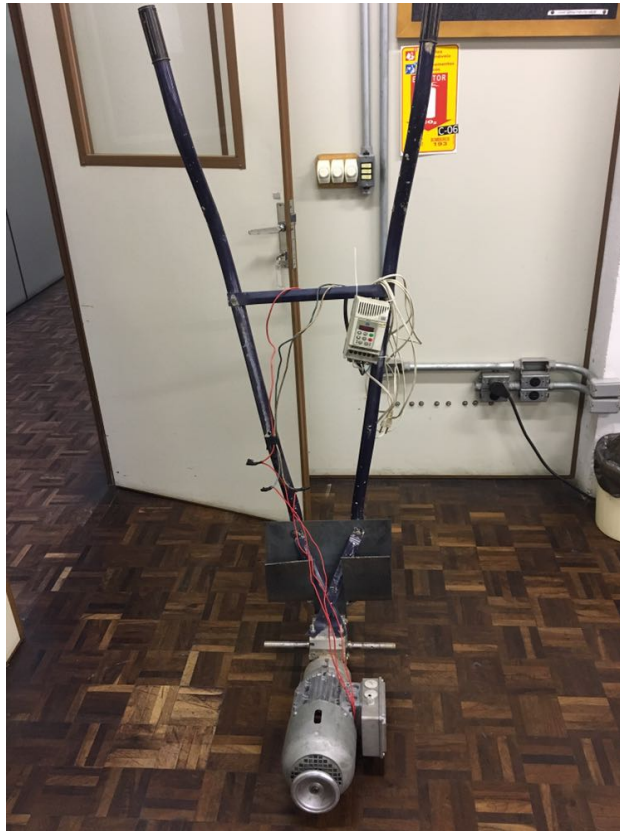
Figura 3 – Estrutura motocultivador elétrico.
