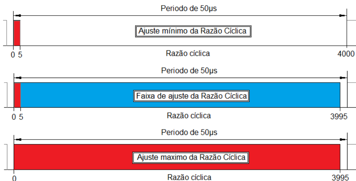
Figura 36 - Faixa de operação da razão cíclica.
