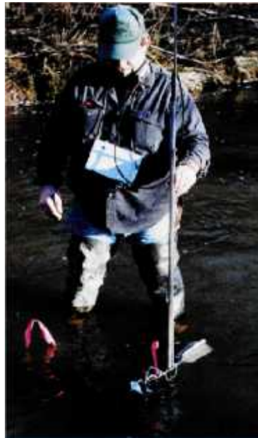
Figura 15 - Medição a VAU Fonte: PORTO, FILHO, SILVA (2001, p.17).
