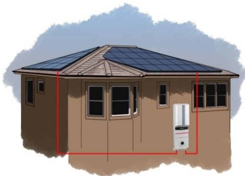
Figura 19 – Inversor com dois canais de MPPT.
